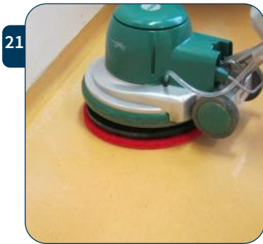
21 Schuur met de rode of blauwe pad en veel water alle resten polymeer en stripper los van de vloer.
