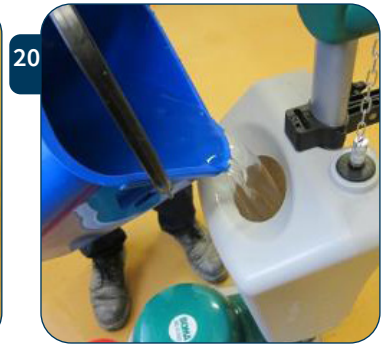
20 Vul de watertank met schoon water, om tijdens het spoelen water bij te doseren op de vloer als deze te droog wordt.
